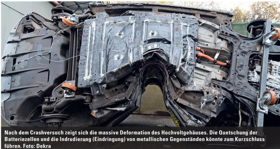
Nach dem Crashversuch zeigt sich die massive Deformation des Hochvoltgehäuses. Die Quetschung der Batteriezellen und die Indrudierung (Eindringung) von metallischen Gegenständen könnte zum Kurzschluss führen. Foto: Dekra
