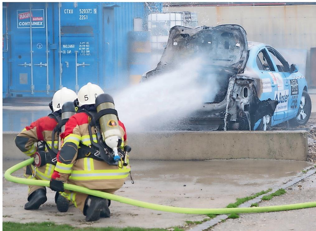
Ein brennendes E-Fahrzeug stellt aufgrund der Hochvoltbatterie keine grössere Herausforderung für die Rettungskräfte dar als ein Fahrzeug mit fossilem Antrieb. Insbesondere gilt es nach der Löschung des Brandes, die Hochvoltbatterie zu beobachten, ob die Temperatur wieder ansteigt. Foto: Baloise
