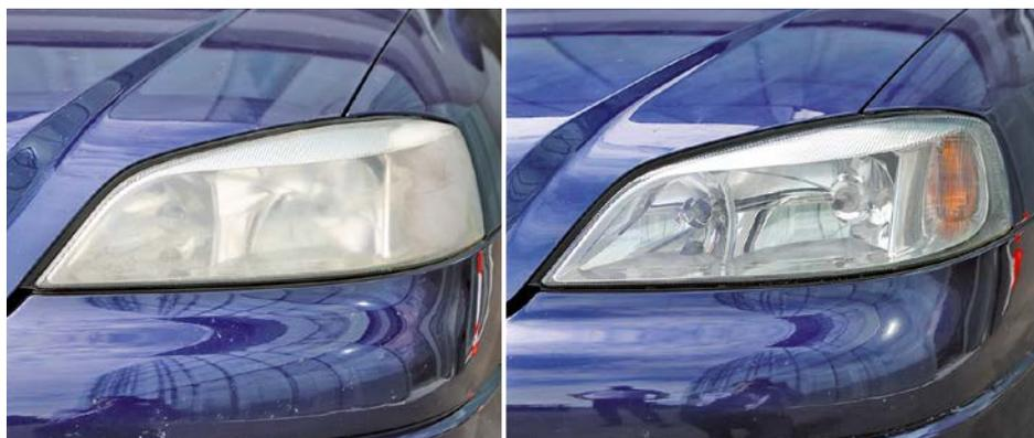
Bild 1. Vergilbte Scheinwerfer mindern die Leuchtkraft und verunstalten das Aussehen des Fahrzeuges. Der Vorher-Nachher-Effekt ist deutlich zu erkennen.
