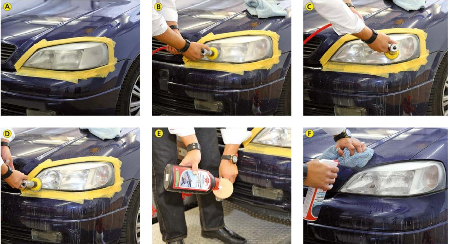
Bild 3. Wichtigste Schritte bei der Scheinwerferaufbereitung. A Umliegende Bauteile mit Abdeckband abkleben. B – D Nass anschleifen mit 1000er, 2000er und 4000er-Schleifpapier. E Polieren mit Schnellschleifpaste. F Versiegeln mit Polymerspray.
