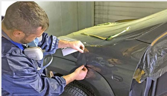
3M PPS Farbtonkontrolle: Die Folie wird zur Farbtonkontrolle am Fahrzeug befestigt.
