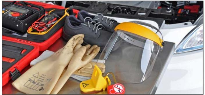
Für Hochvoltanlagen in Hybrid- und Elektrofahrzeugen nutzt der Mechaniker praktisch die gleichen Schutzmassnahmen wie der Elektromonteur (isolierte Werkzeuge und Messgerät, Schutzbrille gegen Funkenwurf, Isolationshandschuhe und -schuhe, Wallbox in Showroom und Werkstatt).
